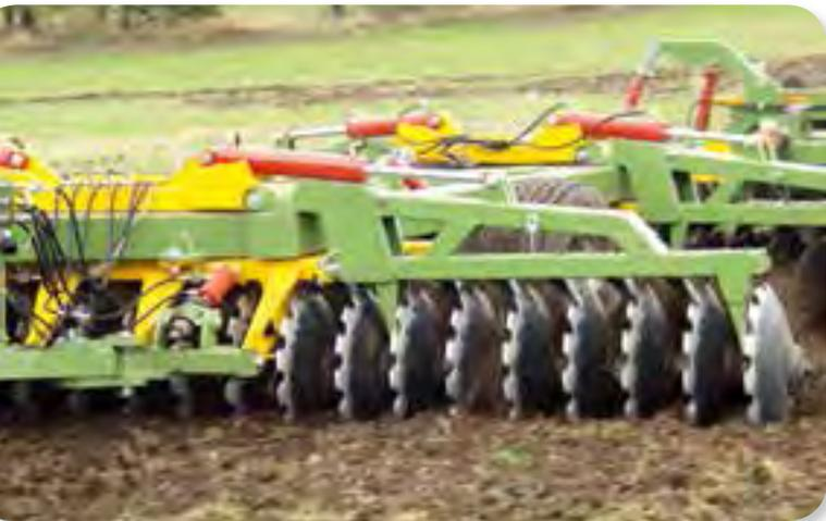
**FRADISC** — тяжелая дисковая борона батарейного типа с давлением до 135 кг на диск, позволяющим без проблем проникать на нужную рабочую глубину. Диск может проникать в почву при необходимости на 15-20 см, так что нет нужды делать второй проход. Это позволяет избежать пыления, налипания лишней почвы и потери влаги. Диски достаточно велики для хорошего проникновения и перемешивания (710 мм) даже при высоком количестве растительных остатков.
