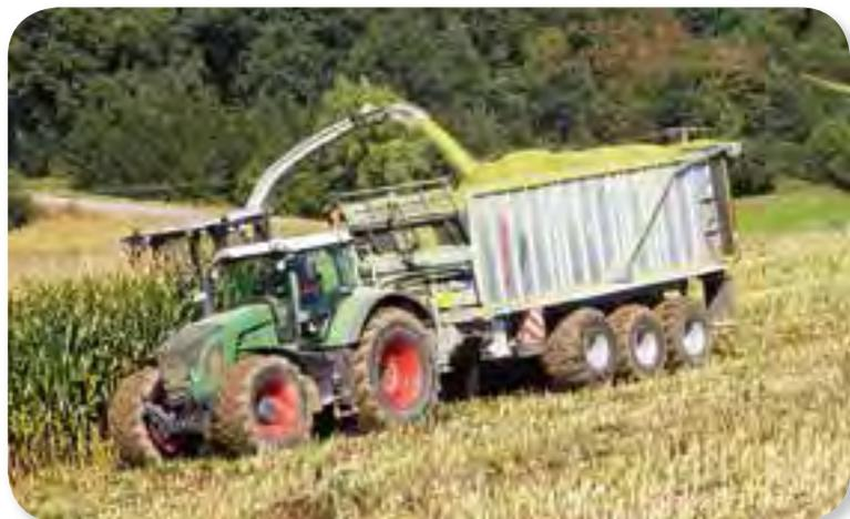
Компания Fliegl Agrartechnik расширяет ассортимент прицепов-вагонов ASW: после выхода алюминиевого полуприцепа с седельным устройством (ASS) Fliegl Agrartechnik в 2014 году представила хорошо зарекомендовавший себя прицеп-вагон из алюминия (ASW). Модельный ряд ASW ALU-TEC имеет одно большое преимущество: значительно меньший собственный вес и, следовательно, возможность увеличения полезной нагрузки. 🍀
