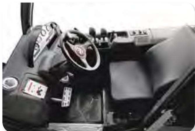
В кабине есть радио, стеклоочиститель (передний, задний и боковой), солнцезащитный козырек и в качестве опции может быть установлен кондиционер. Для работы в темное время суток MLT-X 732 оснащен 2 передними и 1 задним рабочими фонарями.
