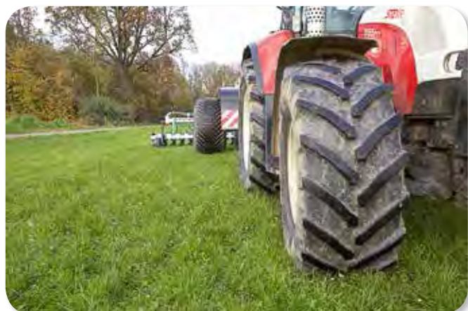
Бережное отношение к почве: телескопические оси позволяют двигаться вне тракторных следов.
