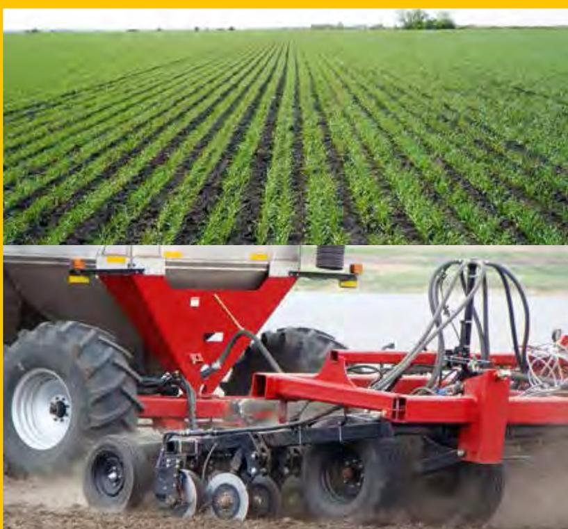
Благодаря такой конструкции высевающей секции зерновые сеялки Single Disc свободно производят посев с сохранением заданной глубины высева при скорости до 16 км/ч.
