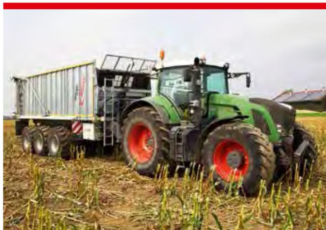
Прицепы-вагоны ASW оснащены универсальными шасси, позволяющими при необходимости вместо кузова устанавливать цистерну. Также к прицепу-вагону можно очень быстро подключить навесное оборудование: навозоразбрасыватель, перегружающий шнек (как для зерна, так и для силоса), перегружающий транспортер, вентилятор для опилок или распределительные вальцы. Такая многофункциональность позволяет использовать прицепы-вагоны круглый год, в том числе и зимой для вывоза навоза и снега на поля.
