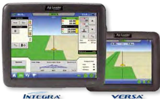
**Дисплей INTEGRA** имеет интуитивно понятный 30-сантиметровый цветной сенсорный экран. Это наиболее полнофункциональное подобное оборудование в отрасли, позволяющее осуществлять мониторинг, картографию, автоматическое вождение и управление всеми полевыми работами с одного прибора.
