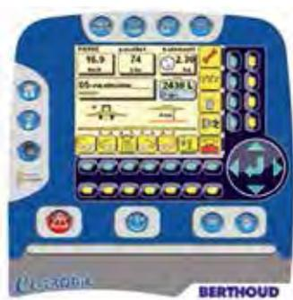
**3** Управление **15 секциями** отдельно посредством выключателей или последовательно при помощи системы BERTHOUD-Pilot.
