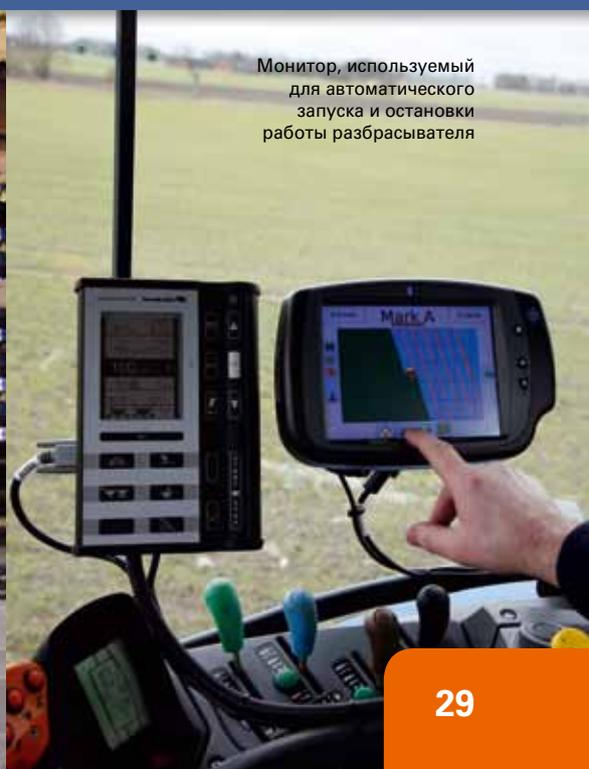
Монитор, используемый для автоматического запуска и остановки работы разбрасывателя
