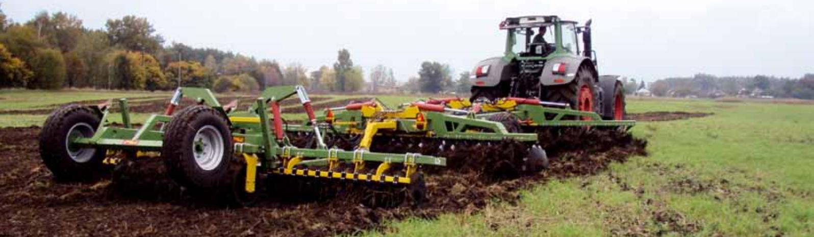
**Д**исковые бороны — более современная и сложная модель по сравнению с классическими зубowymi. Их основным рабочим органом являются наклоненные к поверхности земли диски, производящие рыхление и перемешивание верхнего слоя почвы. В зависимости от назначения можно выделить следующие разновидности дисковых борон: болотные, полевые и садовые. По способу соединения с тяговыми машинами они могут быть навесными, прицепными, а также полунавесными.
