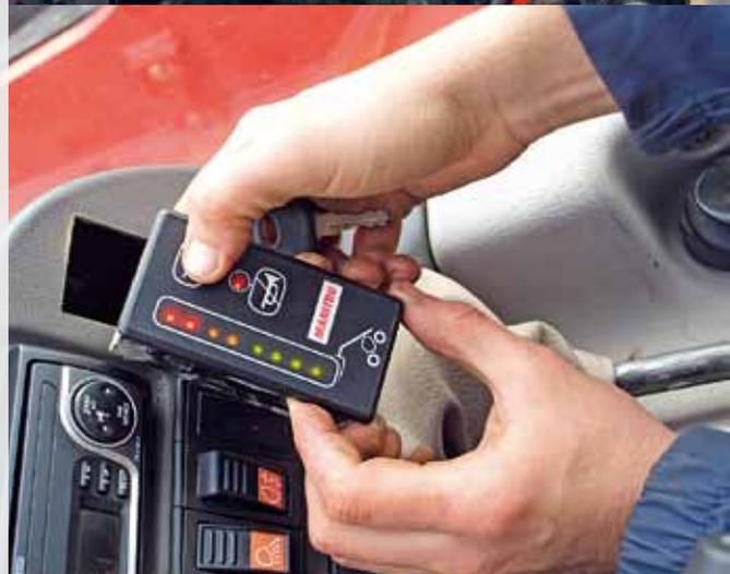
Калибровка датчика перегруза
