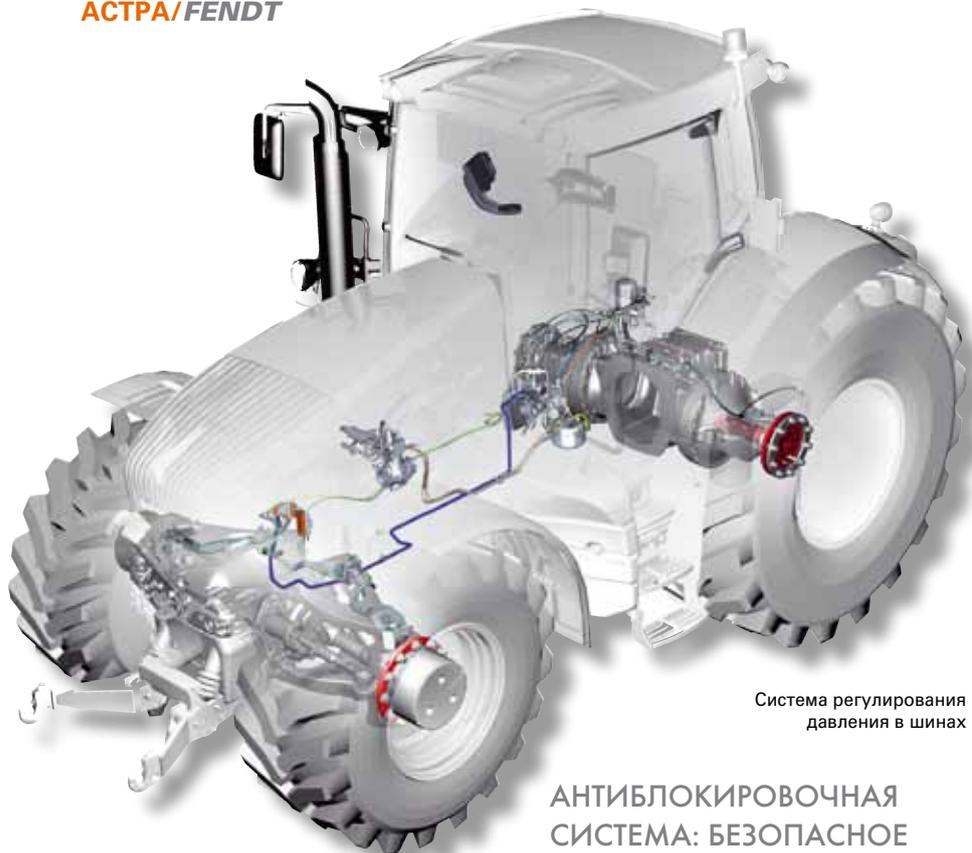
Система регулирования давления в шинах
