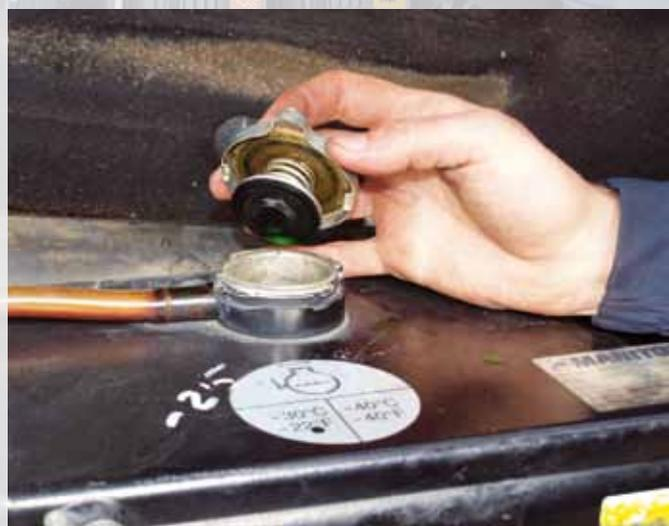
Проверка уровня охлаждающей жидкости
