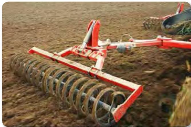
на спираль катка). Эластомерный блок на рукоятке обеспечивает приостановку катка в транспортном положении.
