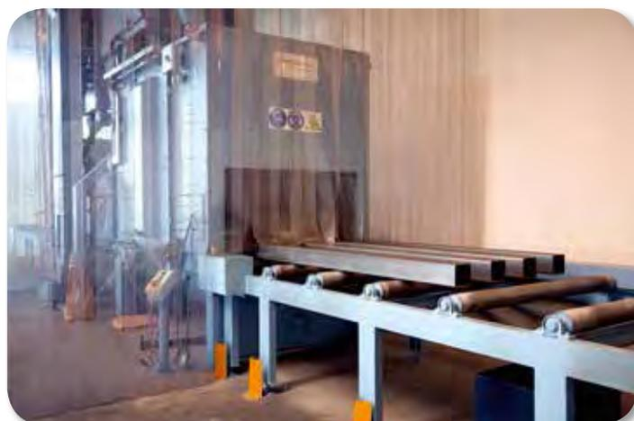
В Vogballe стальные трубы сначала хранят вне помещений, чтобы под воздействием датского климата начался процесс ржавления. Это ослабляет слой оксида на поверхности стали. Поржавевшая поверхность облегчает удаление грязи и очищение стали. Такая обработка — первый этап очистки на долгом пути производства, в результате которого получается идеальная порошковая покраска с максимальным сроком эксплуатации.
