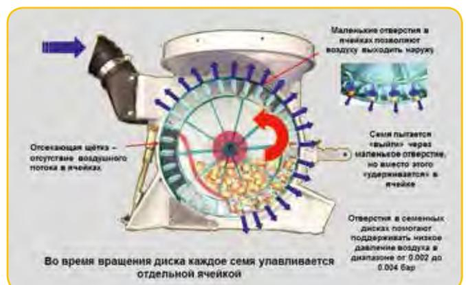
С сеялками Challenger серии 8000 вы забудете о трудностях, связанных с заменой семенных дисков, так как на них установлен винт с большой удобной головкой, позволяющий быстро их менять. При этом нет необходимости использовать какие-либо инструменты или снимать семенной ящик. Все операции производятся вручную.
