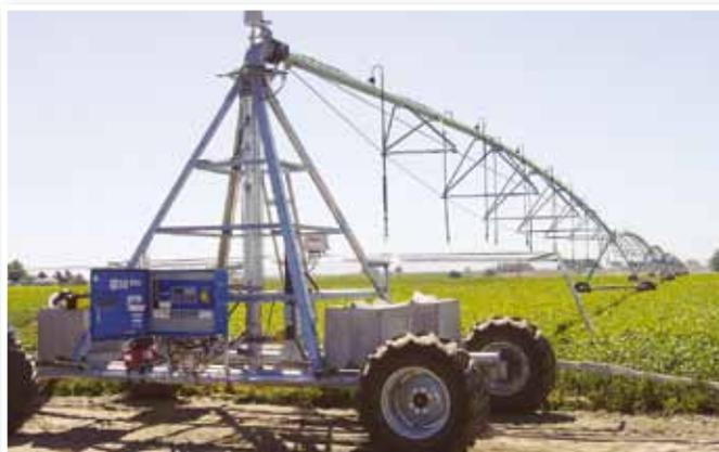
Обеспечивает полив площадей, спроектированных под ДДА-100МА. Буксируется вперед или назад. Ширина полосы полива — 100 м, производительность — 70 л/сек.
