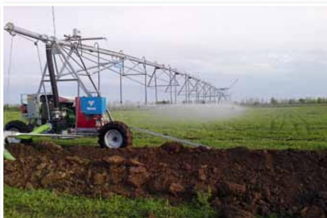
Разработана для применения на полях, где необходима функция разворота. Возможна подача воды по шлангу или из канала, имеется функция разворота и буксировки на другое поле. ■
