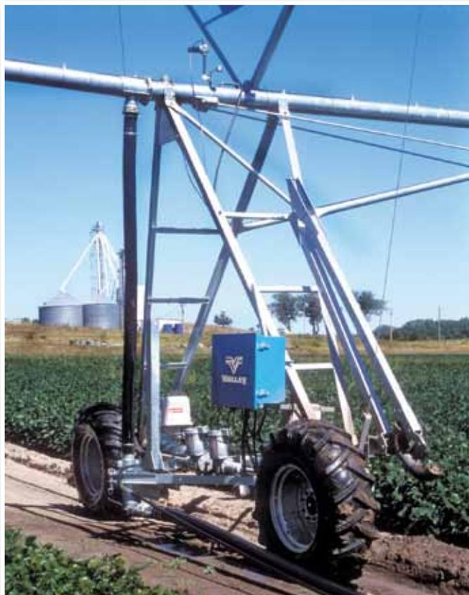
Эта универсальная установка может выполнять функции стандартной фронтальной, буксируемой или поворотной дождевальной установки. Обеспечивает охват площадей как небольших, так и больших полей. Буксируется с одного поля на другое вперед или назад. Возможно наведение по GPS, подземное наведение или наведение по борозде.
