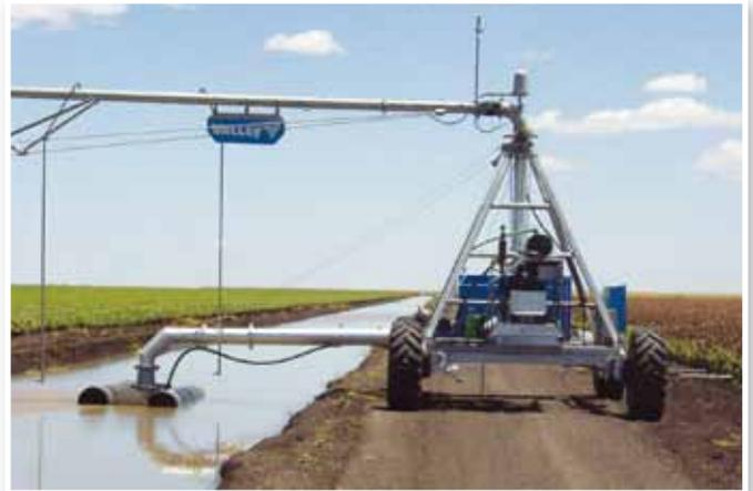
С забором воды из открытого канала. Скорость потока варьируется от 1500 до 8500 л/мин. Общая максимальная длина машины — 518 м. Земляные или бетонные каналы.
