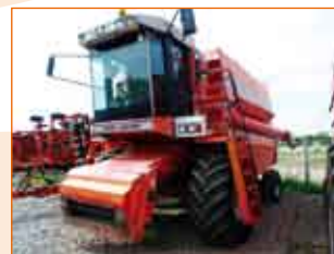
MF 1996 р.в. 235 к.с 5049/3455 м.г. зерновий бункер 6400 л, зернова жатка 5,0 м, подрібнювач соломи, жатка соняшникова Fantini 6-рядна
