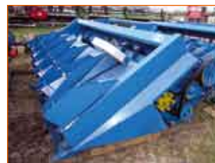
KMC-6 Кукурудзяна 6-рядкова, ширина захвату — 4,2 м., міжряддя — 70 см. 3 стеблеподрібнювачем, для роботи з Massey Ferguson і Fendt.
