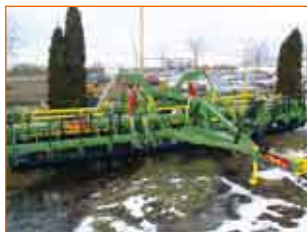
FRAKOMB 4000 NK Ширина захвату — 4м. Необх. потужність — 120-160 л.с. Робоча глибина — до 15 см.
