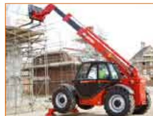
MANITOU MT 1030S 2007 р.в., двигун 82 к.с., виліт стріли — 10 м., вантажопідйомність 3000 кг.
