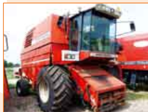
MF 1994 р.в. 265 к.с 5269/3780 мг. зерновий бункер 7900 л. зернова жатка 6.16 PF, подрібнювач соломи, жатка соняшникова Fantini бранда
