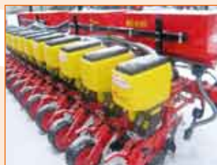
Пневматичні сівалки точного висіву Matermass, 12 рядна, ширина міжряддя 45 см, Необхідна потужність трактора — 90-110 к.с.
