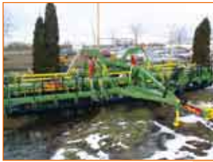
FRAKOMB 4000 NK Ширина захвату — 4 м. Необх. потужність — 120-160 к.с. Робоча глибина — до 15 см.
