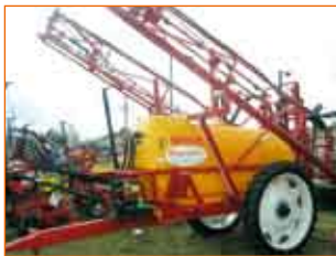
Причіпний оприскувач Vermorel, бак — 2500 л, 18 м ширина штанги, насос ARCA 160 (20 бар), привод насоса від ВВП трактора.
