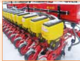
Пневматичні сівалки точного висіву Matermass, 12 рядна, ширина міжряддя 45 см, Необхідна потужність трактора — 90-110 к.с.
