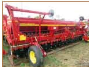
Sunflower 9412-20 Робоча ширина захвату 6,1 м, ширина міжряддя 19,05 см, кількість сошників 32 шт. 3 баками для дрібного насіння.
