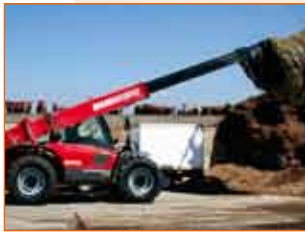
MANITOU 835-120 LSU 2001 р.в., 120 к.с., виліт стріли — 8 м., вантажопідйомність 3100 кг.
