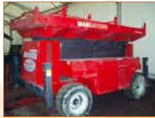
MANITOU 145 DLX 2001 р.в., висота підймання платформи — 14 м. вантажопідйомність — 450 кг.
