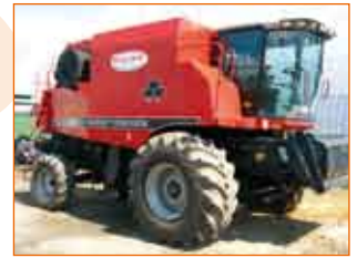
MF 8780 ротор, 2001 р., 309 к.с., бункер 8105 л., подрібнювач соломи, жатка 5,7 м., PF, половорозкидач.
