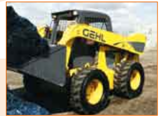
GEHL 4640 2007 р., потужність двигуна 60 к.с., 114 л/хв, маса 2 812 кг, вантажопідйомність 815 кг, без наробітку.
