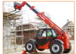
MANITOU MT 1030S 2007 р.в., двигун 82 к.с., виліт стріли — 10 м., вантажопідйомність 3000 кг.
