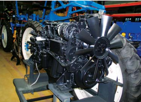
Потужний двигун "Дойц" (236 к.с.) самохідних обприскувачів "Берту"
