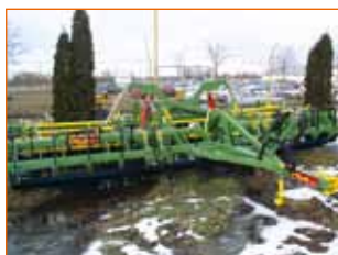
FRAKOMB 4000 NK Ширина захвату — 4 м. Необх. потужність — 120-160 к.с. Робоча глибина — до 15 см.
