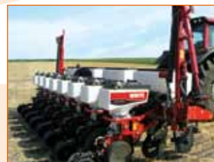
White 8100 Пневматична сівалка 8- та 12-рядна. Міжряддя 70 см, з баком для внесення мінеральних добрив.
