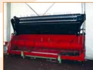
MF 9700 D 1998 р., жатка-підбірочна, для комб. Massey Ferguson і FENDT ширина захвату — 4 м.
