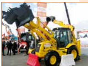
Hidromek 102B Екскаватор-навантажувач 2008 р. Двигун Perkins 101 к.с., гідровихід під гідромолот, телескопічна задня лопата, вантажопідйомність 2935 кг.
