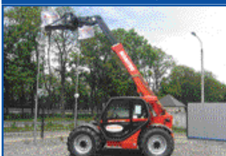
Manitou MLT 731T Турбодизель Perkins 1104.44 T 101 к.с. / 74,5 кВт Интеркулер, максимальна вантажопідйомність — 3,1 т, 7,0 м підйом
