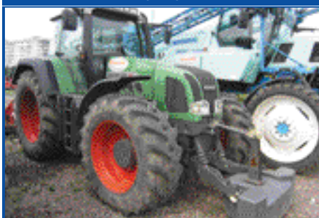
Fendt 920 Vario 2003 р.в., потужність — 220 к.с., наробіток — 3000 м.г.
