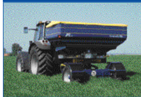
Bogballe M2 Trail Причіпний, робоча ширина захвату — 20–24 м. Об'єм бункера — 3000 л. Необхідна потужність трактора — від 80 к.с.
