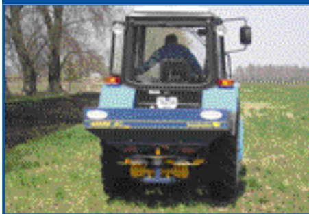
Bogballe L1 Trend Робоча ширина захвату — 12–15 м. Об'єм бункера — 700 л. Необхідна потужність трактора — від 80 к.с. Вага машини — 184 кг
