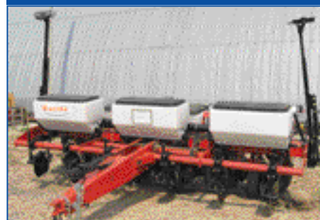
MF 555 6 рядкові Сівалки для нульової, мінімальної та традиційної технології. Жорстка рама. Ширина міжряддя — 70 см, об'єм насіннєвих баків — 705 л, 4 типи висівачих дисків. Глибина посіву регулюється від 1,3 см до 10,2 см. Необхідна потужність трактора — від 100 к.с.
