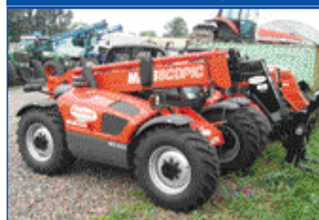
Manitou MT 932 Турбодизель Perkins 1104.44 T 101 к.с. / 74,5 кВт Интеркулер, максимальна вантажопідйомність — 3,2 т, 9,0 м підйом
