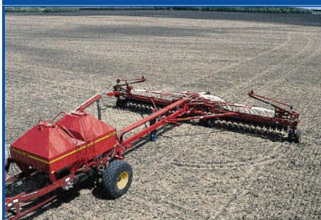
Sunflower 9230-30 Пневматична, трьохсекційна. Робоча ширина — 9,1 м, Ширина міжряддя — 19,05 см, Кількість соняшників — 48 шт. Об'єм насіннєвого бункера — 8 760 л.
