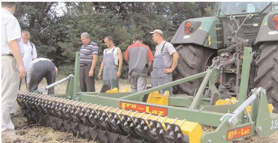
Глубокорыхлитель FRALAZ может взрывать почву на глубину до 500 мм. Рабочую глубину следует проверить перед работой - для определения эффективности работы лап. Слишком большая глубина приводит к большому потреблению топлива, и даже к повреждениям почвенного слоя.
