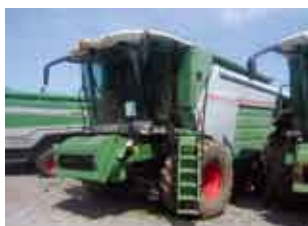
FENDT 8350 350 к.с., жатка 7,7 м, PF, бункер 10 500 л, подрібнювач соломи.
