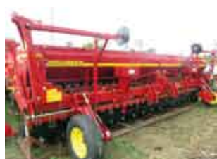
Sunflower 9412-20 Робоча ширина захвату 6,1 м, ширина міжряддя 19,05 см, кількість сошників 32 шт. З баками для дрібного насіння.
