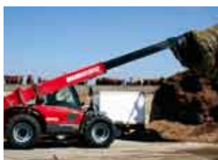
MANITOU 835-120 LSU 2001 р.в., 120 к.с., виліт стріли — 8 м, вантажопідйомність 3100 кг.
