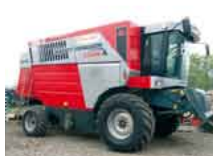
MF 7272 2002 р., 280 к.с., жатка 6,1, FF, подрібнювач соломи, бункер 8500 л.
