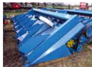
KMC-6 Кукурудзяна 6-рядкова, ширина захвату — 4,2 м, міжряддя — 70 см. Зі стеблеподрібнювачем, для роботи з Massey Ferguson і Fendt.
