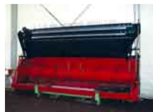
MF 9700 D 1998 р., жатка-підбирач, для комб. Massey Ferguson і Fendt, ширина захвату — 4 м.
