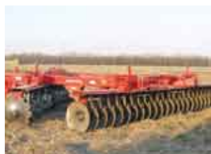
Важка дискова борона Kuhne KNT 7,2 м , V-подібної форми. Необхідна потужність — 310-330 к.с. Диски спереду — «ромашка», позаду — гладкий.
