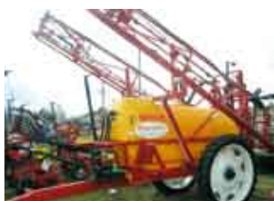
Причпний опрыскувач Vermorel , бак — 2500 л, 18 м ширина штанги, насос ARCA 160 (20 бар), привід насоса від ВВП трактора.
