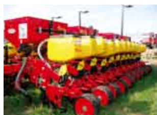
Пневматичні сівалки точного висіву Matemass , 12-рядна, ширина міжряддя 45 см. Необхідна потужність трактора — 90-110 к.с.
