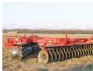
KUHNE 7.2 тяжелая дисковая борона V-образная необходимая мощность трактора 310-330 л.с.
