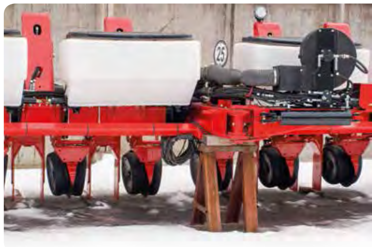
Установка техники на стойки и подставки
