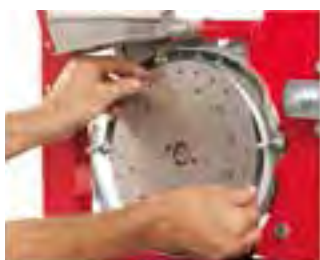
Легкозаменяемый высевной диск из стали
