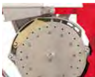
Селектор из бронзы плотно прилегает к диску
