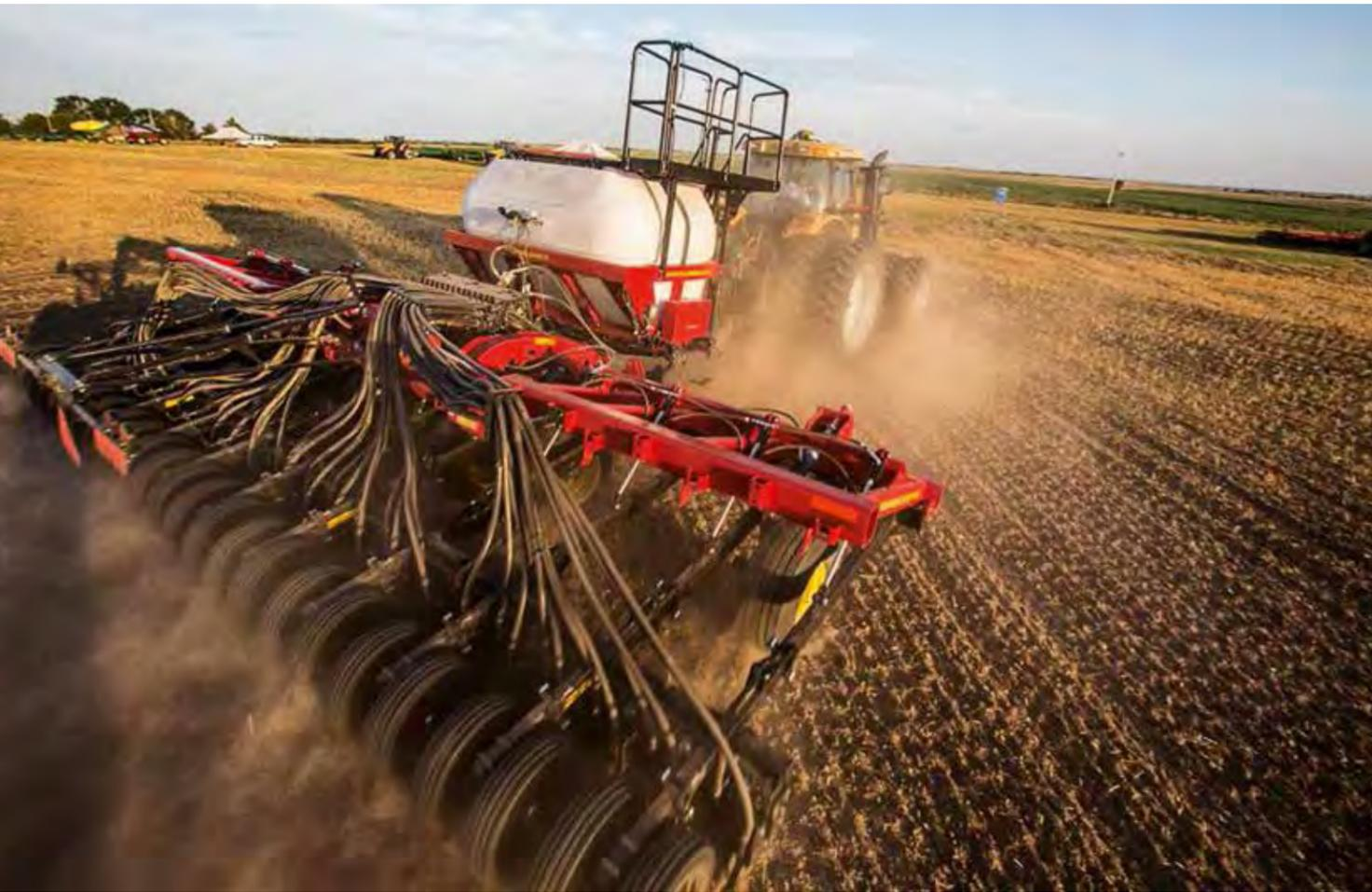
Новая модель выполнена на основе проверенных технологий, которые на протяжении долгого времени применяются в линейке пневматических сеялок Challenger серии 9000. Однако, хотя сеялки Challenger разработаны и производятся в США, данная серия обладает одним «неамериканским» свойством — европейской транспортной шириной. Ширина оборудования в транспортном положении составляет 3,5 м, при этом рабочая ширина захвата равна 9,14 м.
