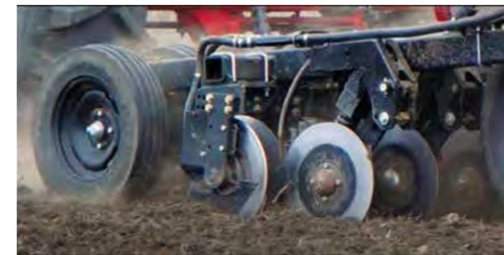
сева в одиночной секции дозирования. Каждая секция сеялки СН 9830NT способна поддерживать необходимую норму высева продукта, контролируя скорость каждой высевающей катушки, базирующейся на индивидуальной ходовой скорости секции. Управление переменной нормой позволяет точно вносить семена и удобрения из обоих отсеков по всему полю в соответствии с агрономическими требованиями для увеличения урожая.
