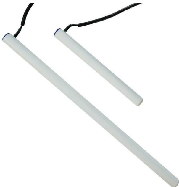
Датчики Sentek Drill & Drop – это герметичный почвенный зонд, предназначенный для установки в почву для измерения содержания влаги, температуры и, при желании, солености почвенного раствора.
