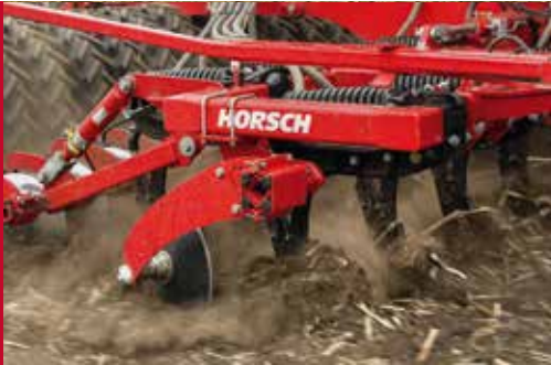
Узкие LD-лапы рыхлят почву в местах рядов посева и адресным способом закладывают депо удобрений
