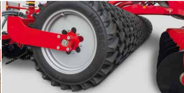
Колёсный почвоуплотнитель для выдерживания глубины обработки и уплотнения посевного ложа перед посевом.
