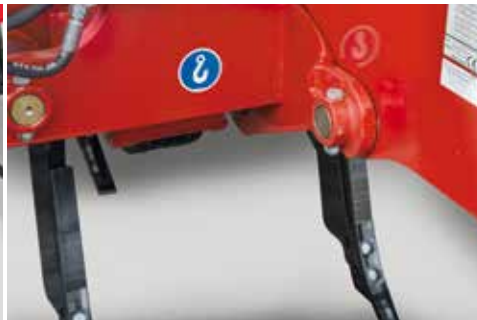
Удобное переоборудование рабочих органов. Замена рам со стойками на дисковые батареи происходит посредством 4 резбовых соединений.
