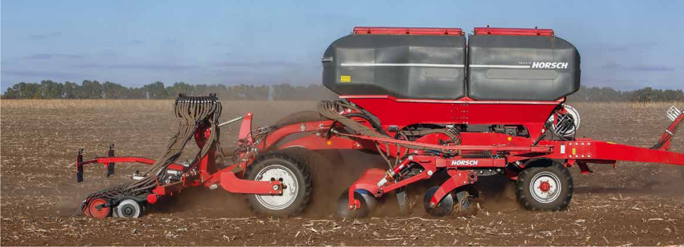
Четыре зоны Focus TD Высевающие сошники TurboDisc – колёсный почвоуплотнитель – выравнивающие диски – стойки TerraGrip с узкими LD-лапами для внесения удобрений
