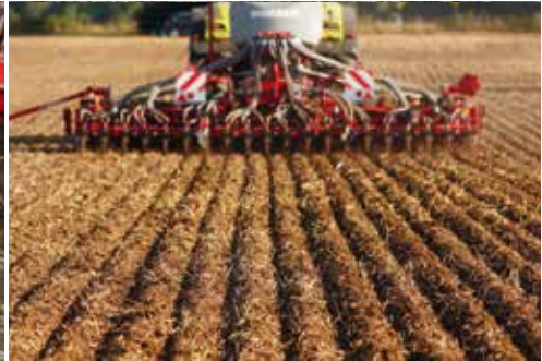
Сошники TurboDisc заделывают семена в борозде с мелкокомковатой пи освобожденной от растительных остатков почвой
