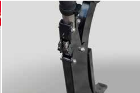
Закладка депо удобрений возможна в нескольких вариантах: глубоко/в поверхностном слое или смешанным способом 50 : 50
