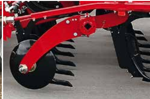
Крайний диск Позиция и угол атаки регулируются в соответствии с почвенными условиями и глубиной обработки.
