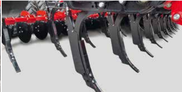
Стойки TerraGrip с узкими LD (lowdisturbance) лапами глубоко рыхлят почву под рядами посева культуры и освобождают зону роста корневой системы от растительных остатков
