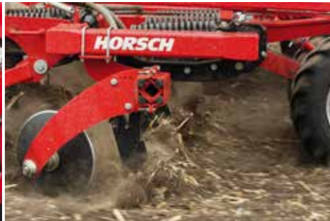
TerraGrip III L Сила срабатывания 630 кг
