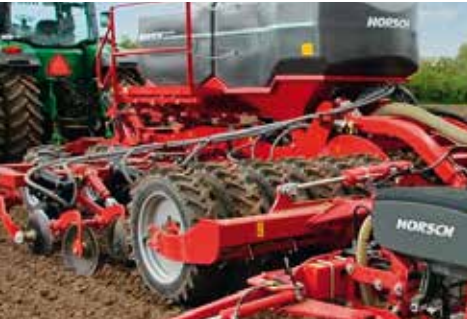
Focus TD с 3-точ. навеской и посевными модулями Maestro RC
