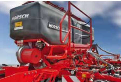
Удобная лестница с рабочей платформой для заправки и контроля бункера
