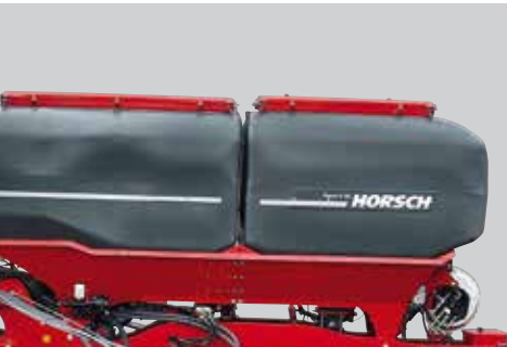
Бункер объёмом 5 000 л (Бункеры: 2 000 л спереди – 3 000 л сзади)
