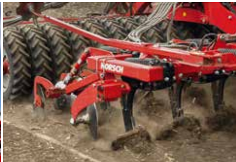
Каждая стойка TerraGrip расположена строго напротив колеса почвоуплотнителя
