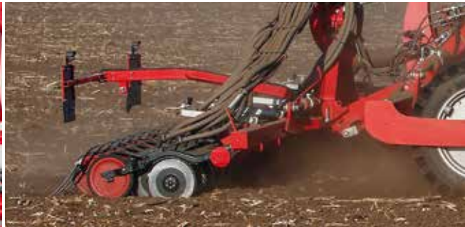
Исключительная способность сошников TurboDisc с интегрированным прикатывающим роликом копировать (до 15 см) микрорельеф поля является залогом точной выдержки заданной глубины посева. Высокая степень прижатия сошников (до 120 кг/сошник) делает возможным качественный сев на высокой скорости.
