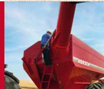
Лестница обеспечивает быстрый доступ к бункеру для очистки и ТО.
