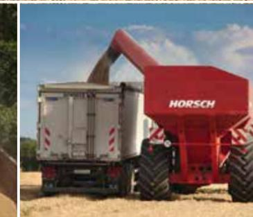
Благодаря телескопической оси достигается более высокая стабильность бункера и уменьшается нагрузка на почву
