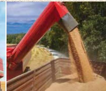
Выгрузной шнек с производительностью 18 тонн/минуту, что означает 1 000 тонн/час.
