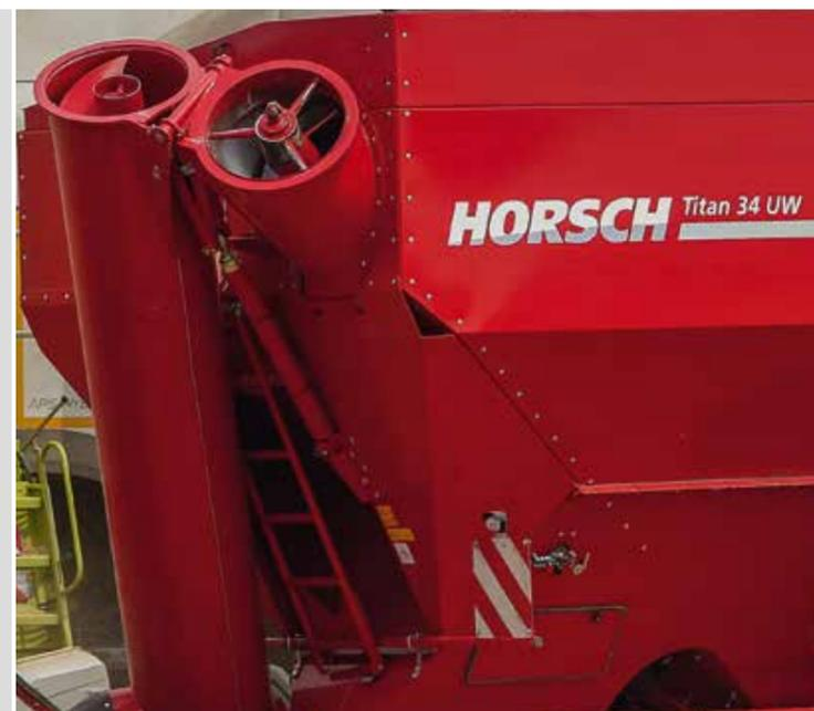
Гидравлически складываемый шнек имеет производительность 18 тонн/минуту и полностью разгружает бункер за 90 секунд.
