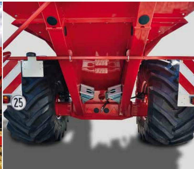
Телескопическая ось позволяет раздвинуть колёса с 3 до 3,56 м. Таким образом улучшается стабильность машины и уменьшается давление на почву.
