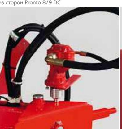
Отключение высева одной из сторон Pronto 8/9 DC
