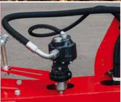
Гидр. вентилятор с приводом от ВОМ
