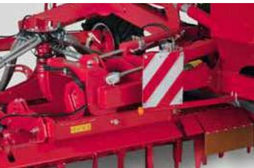
Защитные сходни над дисковой бороной для удобного доступа ко всем узлам машины
