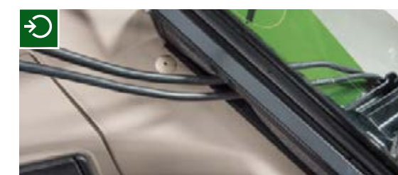
■ Fendt предлагает оригинальное решение для кабелей, идущих в кабину со стороны задней части трактора. Кабели любого сечения могут быть заведены через специальный ввод. Заднее окно можно закрыть, чтобы в кабину не попадала пыль, грязь, вода и шум.
