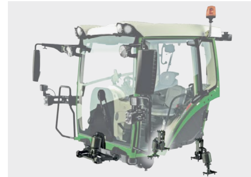
□ Подвеска кабины с пневмопружинами сводит к минимуму вибрацию кабины. Значительная разница по высоте и большое расстояние между пружинными элементами кабины X5 также предотвращает раскачивание и обеспечивает максимальный комфорт при движении.
