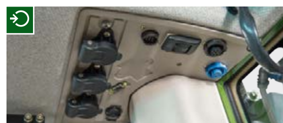
□ В кабине предусмотрено множество разъемов, включая несколько розеток питания 12 В, разъем ISOBUS и сигнальный разъем.
