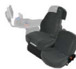
□ Кресло "Evolution dynamic Dualmotion" с пневматической подвеской: регулируемое положение спинки, подогрев, адаптер поворота, низкочастотный амортизатор, пневматическая опора для поясницы и регулируемые подлокотниками. Чехол для сиденья может быть выполнен из черной ткани или из гладкой черной кожи (в комплект также входит кожаный чехол для рулевого колеса).
