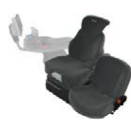
■ Удобное сиденье оснащено пневматической подвеской, положение подлокотника легко регулируется.
