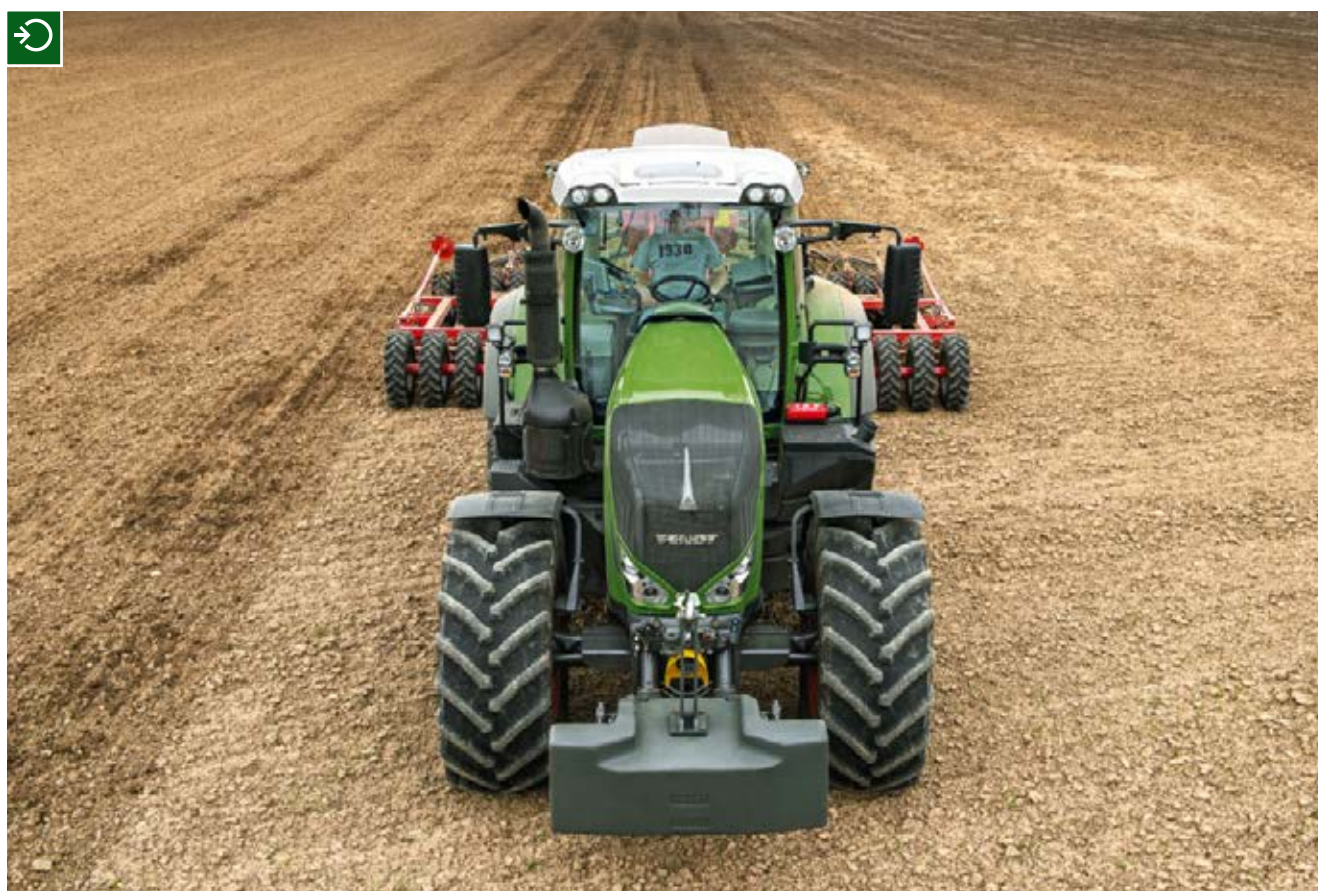
При создании Fendt 800 Vario особое внимание уделялось обеспечению оптимального обзора. Капот выполнен максимально узким, поэтому водителю прекрасно видны колесные арки и переднее навесное оборудование.
