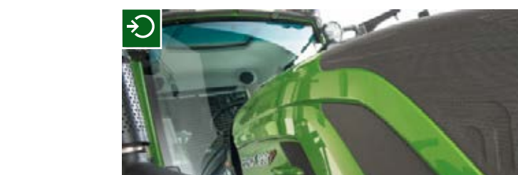
□ Особенностью тракторов Fendt является вклеивание ветрового стекла. Данное решение не только улучшает обзор, но и гарантирует отсутствие скрипа и протечек по периметру стекла. Стекло оборудовано электроподогревом.
