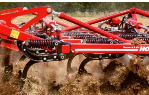
TerraGrip III с силой срабатывания 550 кг
