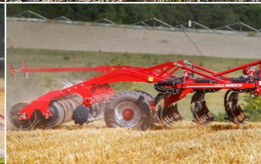
Маневренность вследствие шасси в центре машины
