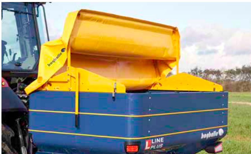
Тент на бункер з механізмом для складання і розкладання
