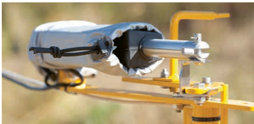
Електричне дистанційне керування розповсюдженням від краю CALIBRATOR ZURF / ICON
