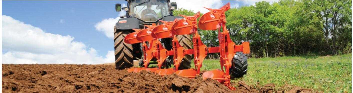
**MASTER 153** плуги були розроблені відповідно до тих же вимог, що й серія 123, але призначенні для більш інтенсивного використання та складніших умов роботи з більш потужними тракторами від 95 до 270 к.с..
