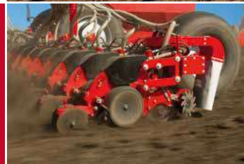
Надёжная и точная высевающая секция HORSCH – здесь в варианте Seed on Demand
