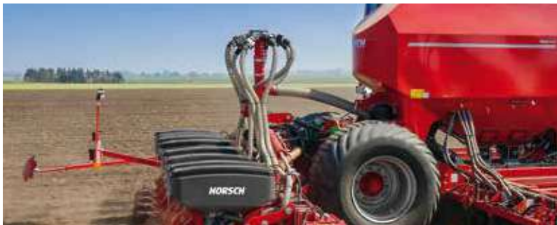
Распределитель потока семян и 3-точ. навеска ( Maestro RC )
