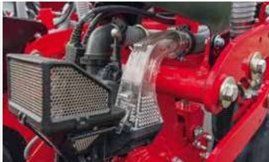
Maestro SW: дозатор в исполнении Seed on Demand
