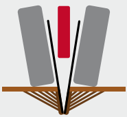
Уплотнение борозды стандартными прикатывающими роликами
