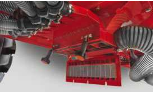
Открытый модуль распределительный системы Seed on Demand Maestro SW – вид снизу
