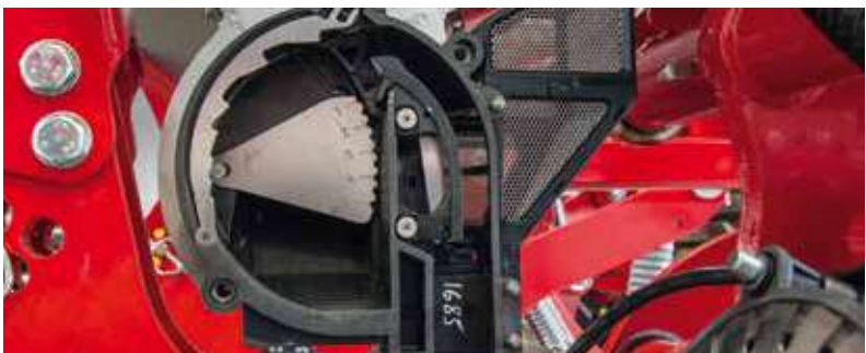
Регулируемый отсекаль направляет семя в трубку семяукладчика без возникновения центробежных сил
