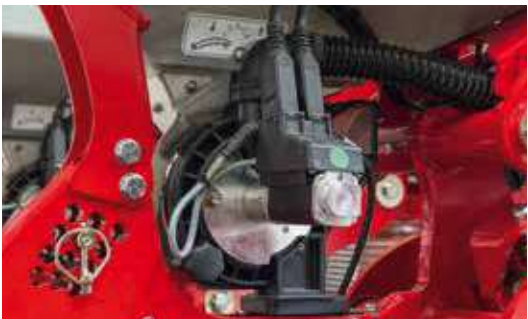
Запатентованная система дозировки – уникальна (на 09.2011) и объединяет пневматический дозатор, электромотор и модуль управления в одном блоке
