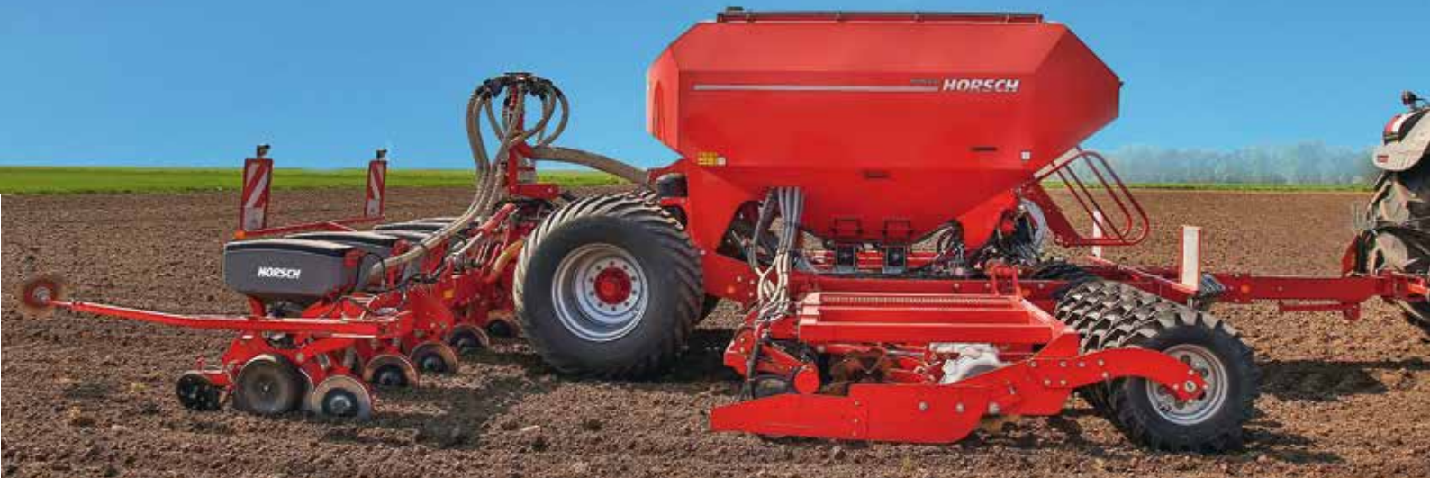
Maestro RC : Посевная секция Maestro (8- или 12- модулей) в комбинации с бункером для удобрений от Pronto AS. Замена высевальной шины между Pronto и Maestro с помощью 3-точ. сцепки.
