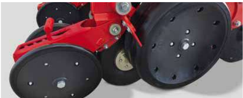
Опорный ролик со скребком, регулируемый по высоте прикапывающий ролик и ролик-семяуспокоитель, который в условиях повышенной влажности может быть демонтирован
