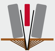
Шпоровые или пальчатые ролики продавливают уплотненный опорными роликами сошника слой почвы.
