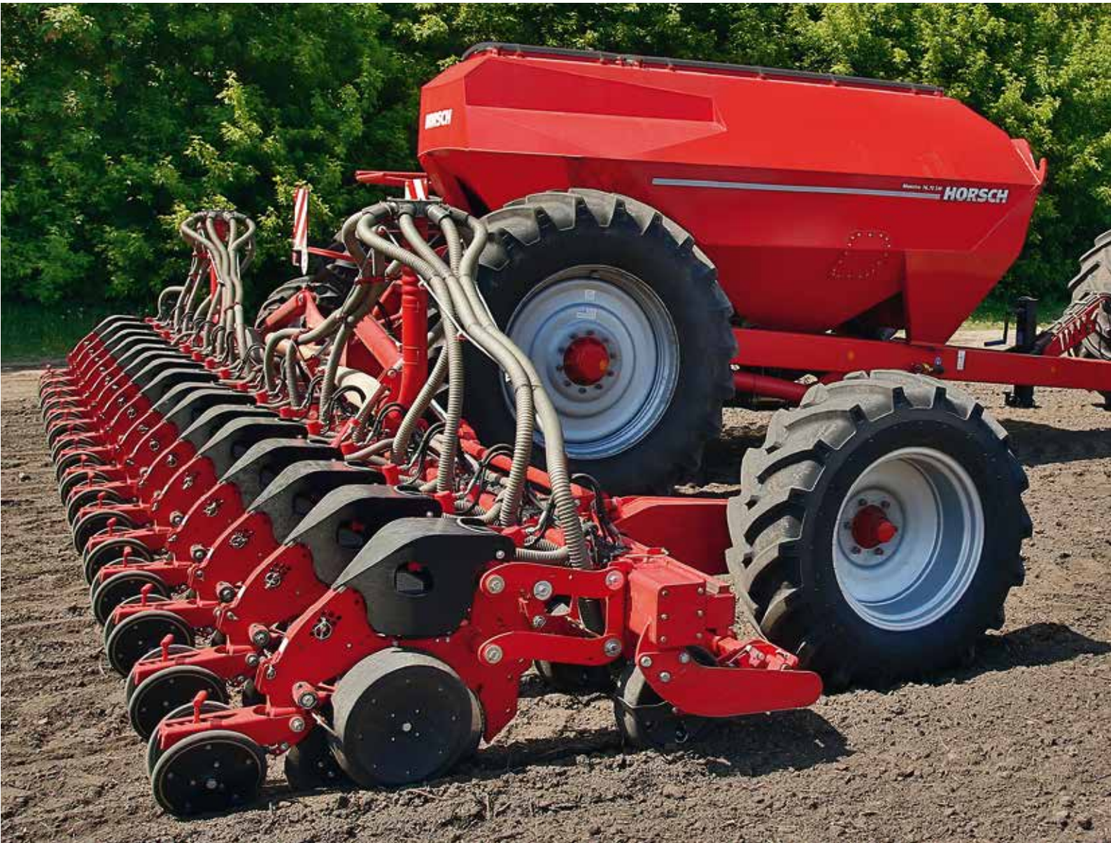
Опорный ролик со скребком, регулируемый по высоте прикапывающий ролик и ролик-семяуспокоитель, который в условиях повышенной влажности может быть демонтирован
