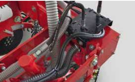
Гидравлическое регулирование давления на сошники для Maestro SW
