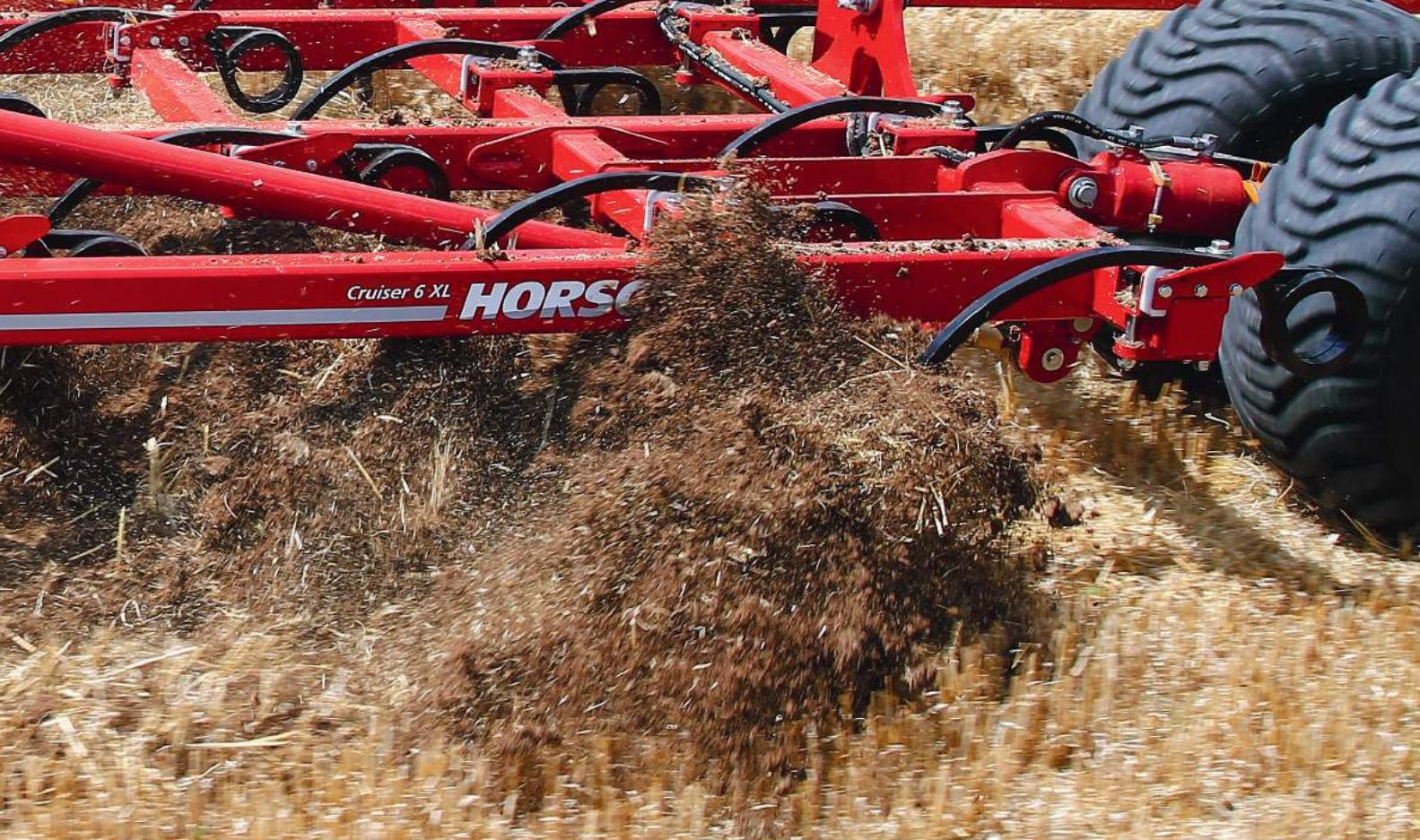
Новая геометрия пружинных стоек HORSCH Federzinken обеспечивает солидную высоту подъема стойки с минимальным ходом сжатия пружины. Это инновационное решение существенно уменьшает износ материала и заметно увеличивает срок службы детали.
