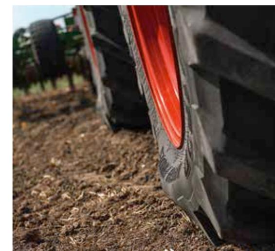
→ При выбранной скорости, вспомогательная система Grip Assistant отображает значение подходящего давления в шинах и массы балластов при заданной скорости. При выбранной массе балластов, система показывает значение рекомендованной рабочей скорости и давления в шинах.
