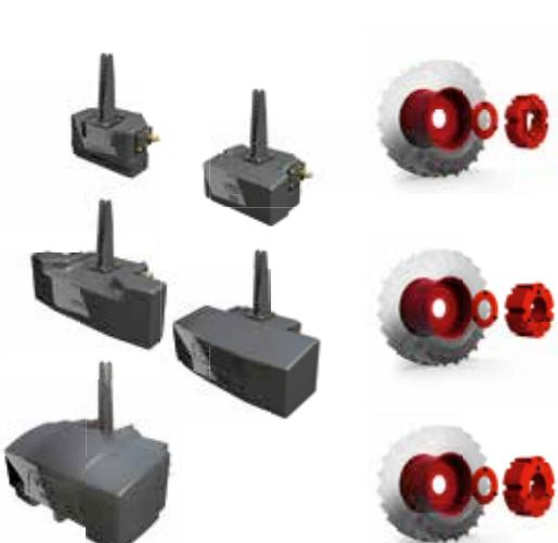
Fendt Vario 1000 имеет различные варианты балластировки, а именно передние противовесы весом от 870 кг до 3300 кг, и колесные грузы весом от 2 x 650 кг до 2 x 1250 кг.
