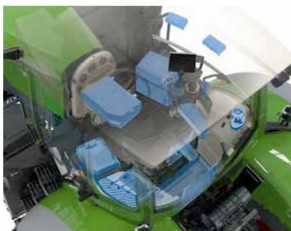
Мультифункциональный подлокотник в комплектацией Power с Varioterminal 7-B; джойстик Power, кнопками круиз-контроля и предустановленных оборотов двигателя; органы управления навесками, MOM; Varioterminal 7-B с настоящей стеклянной поверхностью обладает интуитивной навигацией в меню, сенсорным и кнопочным управлением, а также системой управления рабочими орудиями, совместимыми с ISOBUS.
