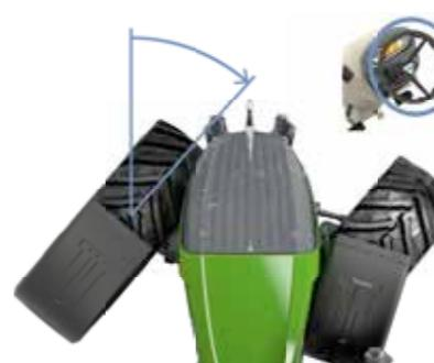
Благодаря VarioActive полный поворот колес выполняется уже после одного оборота рулевого колеса.
