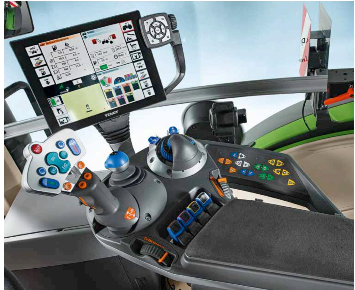
Элементы управления расположены на правом подлокотнике – Varioterminal 4-в-1, многофункциональный джойстик, крестообразный рычаг, модуль управления навесками EPC, управление гидрораспределителями и мембранный клавиатура создают хорошо сбалансированный общий дизайн и образуют эргономичный командный центр, где все находится под контролем.
