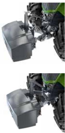
Передний силовой подъемник полностью интегрирован в машину.
