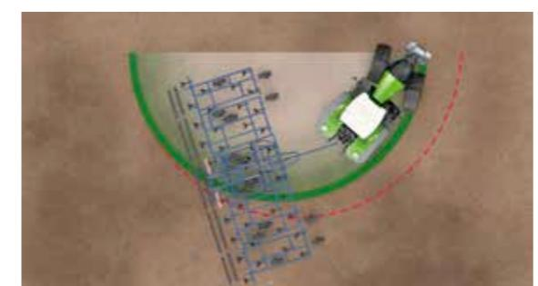
Малый радиус поворота благодаря эффекту «pull-in turn», например, 6,97 м для Fendt Vario 1038 со стандартными шинами.
