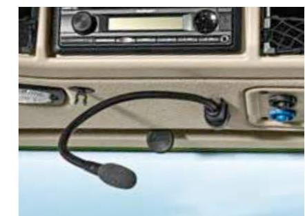
В Fendt 1000 Vario вы можете делать звонки отличного качества на громкой связи: гибкий удлиненный микрофон позволяет освободить руки и имеет отличную акустику.
