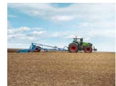
Благодаря системе управления трактором TMS и автоматической системе регулирования предельной нагрузки 2.0, трактор подбирает оптимальные обработы двигателя к текущей скорости движения.
