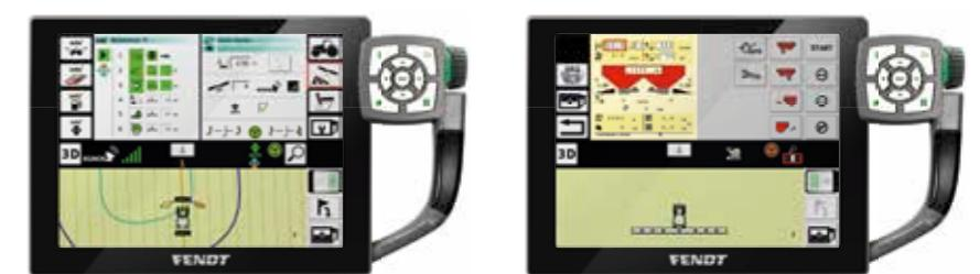
Автоматизация разворотной полосы Variotronic<sup>TM</sup> позволяет снизить нагрузку на оператора при выполнении разворотов. Variotronic<sup>TM</sup> автоматически выполняет точную последовательность в нужном месте.
