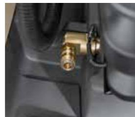
Кабину также можно быстро очистить: Сиденья водителя (комфортное сиденье класса люкс Evolution) оснащены удобным подключением для пневмошланга, с помощью которого можно очистить кабину.
