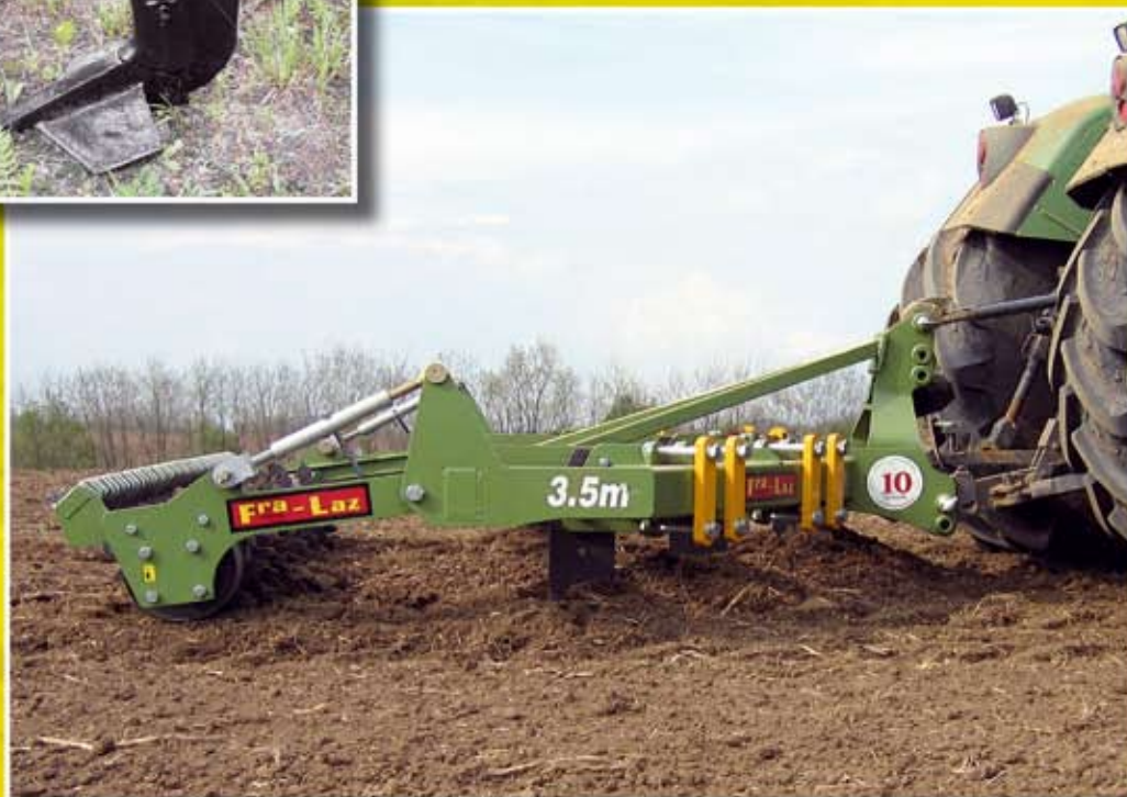
Узкий наконечник с наклонным под углом крыльям в интересах хорошей прорезающей способности
