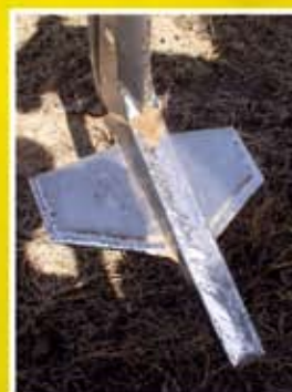
Узкий наконечник с наклонным под углом крыльям в интересах хорошей прорезающей способности
