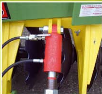
Гидрорегулирование передней навески обеспечивает точность регулирования продольного крена
