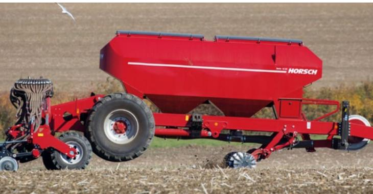
Двухкамерный бункер 60:40 (3 600 л спереди и 2 400 л сзади)
