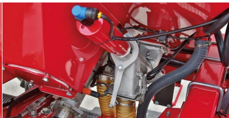
Шнековый дозатор для микрогранул
