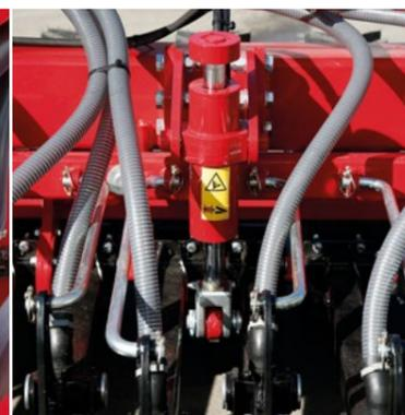
Гидр. бесступенчатая регулировка давления сошников
