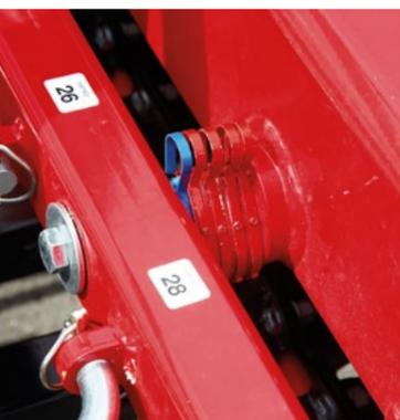
Регулировка глубины посева
