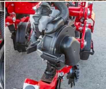
Дозатор AirSpeed с системой Main Tank Supply
