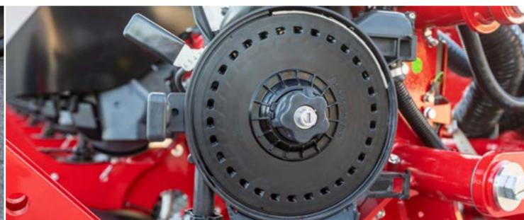
Диск с 30 отверстиями для кукурузы для дозаторов AirVac и AirSpeed
