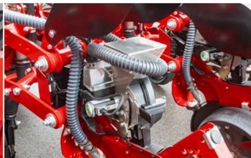
Дозатор AirVac для Main Tank Supply (MTS) системы
