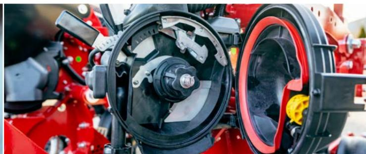
Дозатор AirSpeed с закрытой заслонкой камеры заполнения и универсальным семясемеником, не требующим тонкой настройки.
