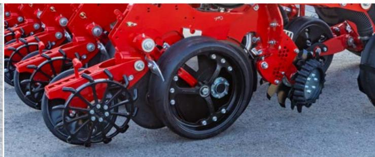
Спицевые опорные колеса, регулируемые уплотняющие ролики и ролик-семяукладчик для филигранной заделки семян.
