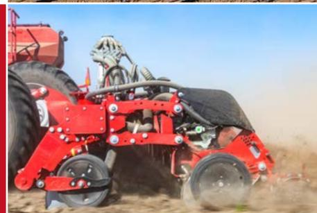
Массивные высевальные секции с индивидуальной системой точного дозирования и Main Tank Supply System
