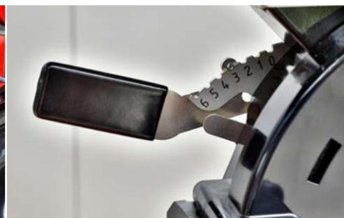
Регулировка заполнения дозатора
