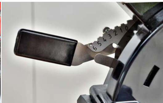
Регулировка заполнения дозатора
