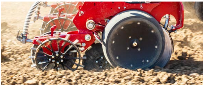
Ролики для ведения по глубине со скребком, регулируемые уплотняющие ролики и ролик-семяукладчик, который в моделях CV можно демонтировать во влажных условиях.
