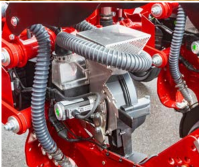
Дозатор AirVac с системой Main Tank Supply
