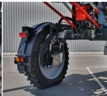
Гибкость в изменении ширины колеи и высоты рабочего просвета благодаря шасси ComfortDriveFlex
