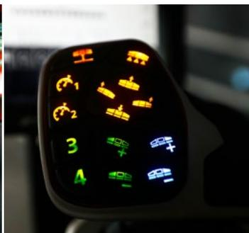
Джойстик ErgoControl для управления в режиме опрыскивания со свободно программируемыми кнопками
