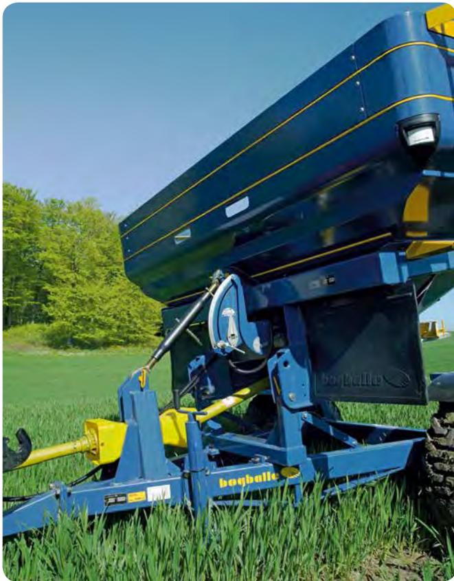
Разбрасыватели Vogballe покрыты сверхстойчивой к коррозии порошковой краской Flexi Coat, защищающей машину от агрессивной среды, рабочие органы сделаны из нержавеющей стали, лопатки — из высокопрочной марганцевой стали. Все детали предварительно обрабатываются таким образом, чтоб не оставалось острых углов и краска не «прорывалась» во время эксплуатации.
